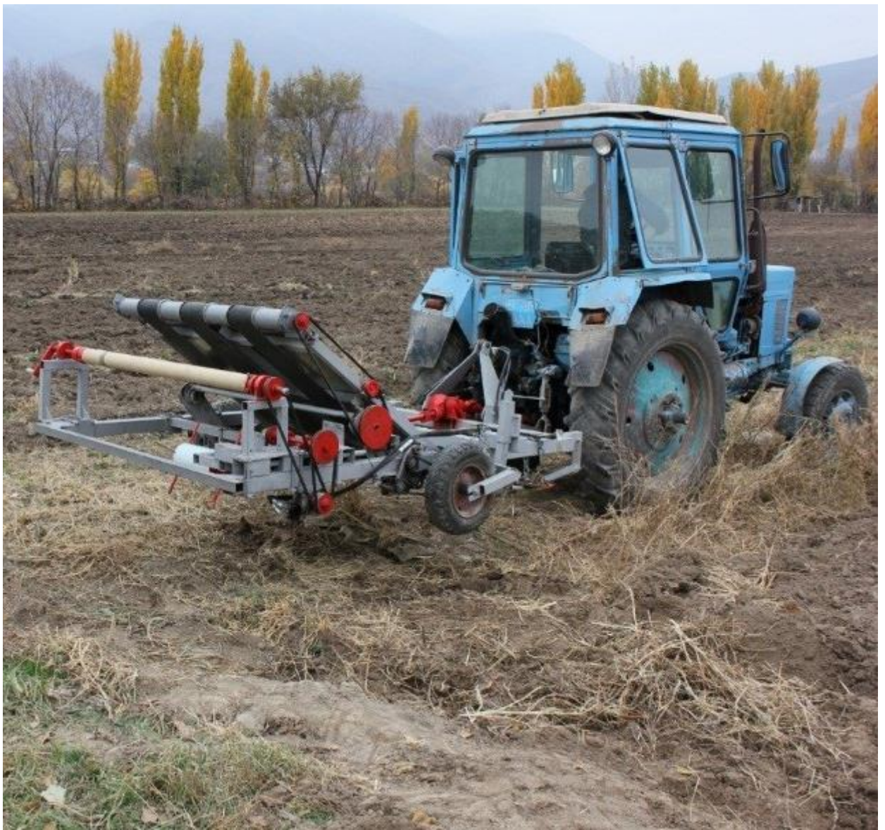
Разработанный на базе КазНАИУ агрегат для удаления мульчирующей пленки и гибких поливных лент капельного орошения с поля в после уборочный период
