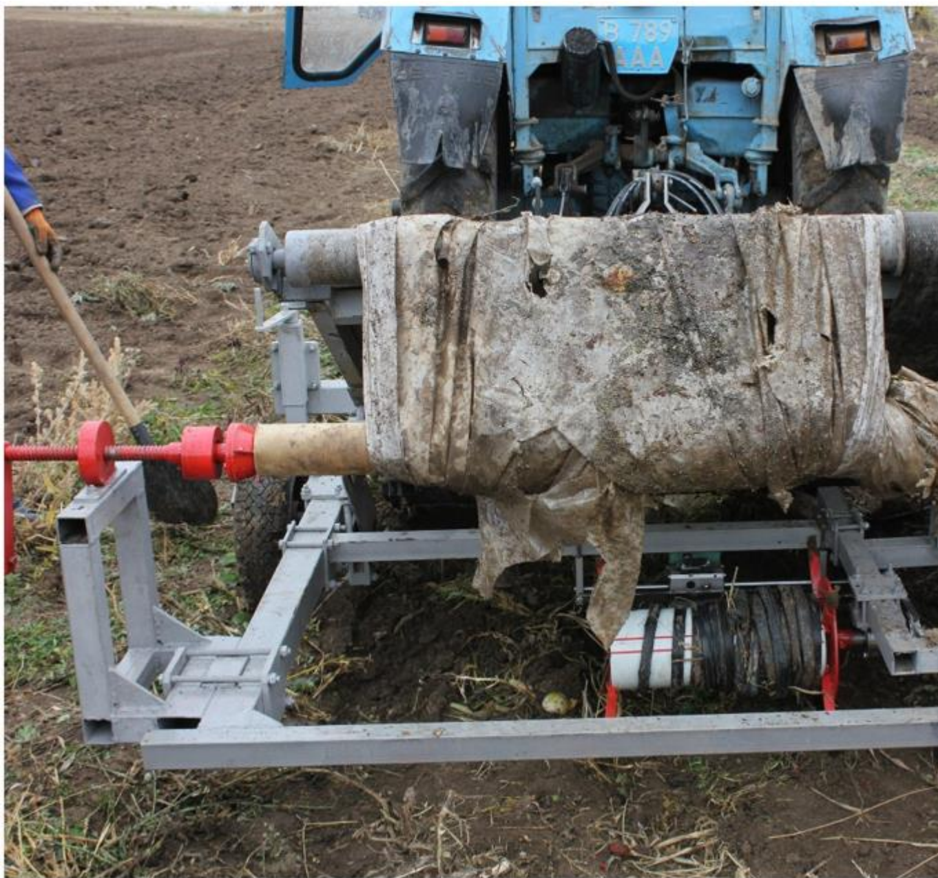
Испытание устройства для сборки мульчирующей пленки и гибких поливных лент совместно и раздельно
